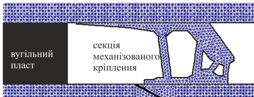
Рисунок 2 – Центральний фрагмент скінчено-елементної сітки
