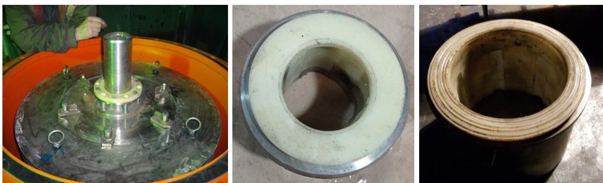
Рисунок 1 – Вироби з поліаміду у фільтрах технічної води поліамідне торцеве ущільнення (а), підшипник ковзання новий (б), підшипник ковзання після 7 років експлуатації (в)
