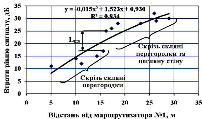
Рисунок 2 – Залежність втрат рівню сигналу від відстані та типу перешкод
