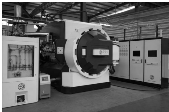
Рис. 2 Вакуумна електрична піч
