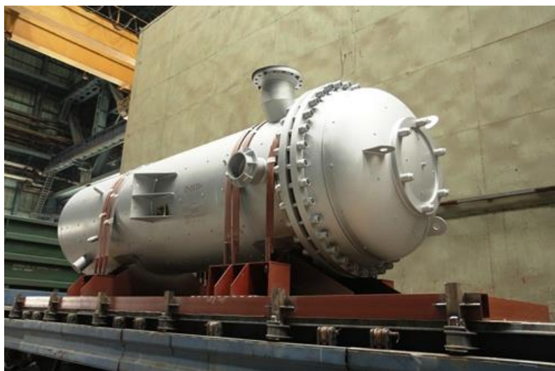
Рис. 1 Зовнішній вигляд ПНТ блоку 300 МВт
