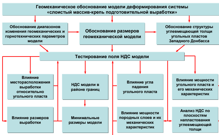
Рис. 1. Структурная схема геомеханического обоснования модели деформирования системы «слоистый массив-крепь подготовительной выработки»
