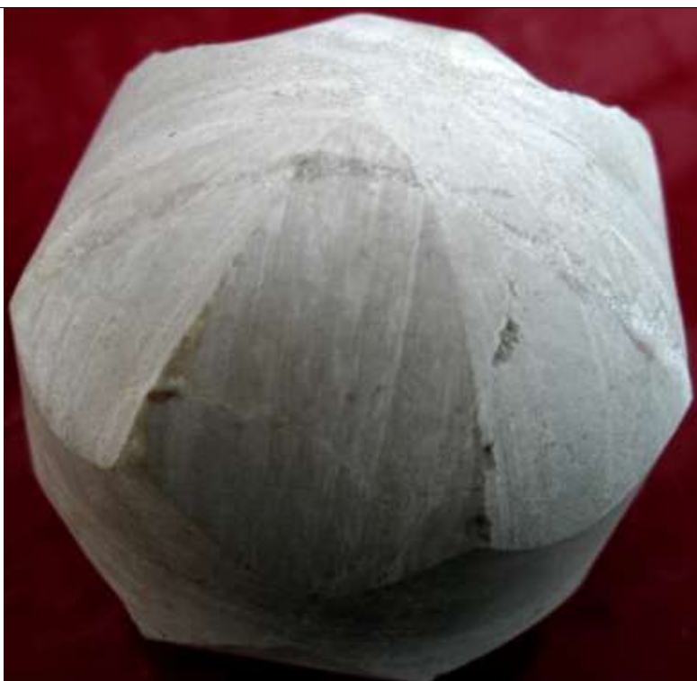
Рис. 1. Форма поверхности тела после разбуривания образца
