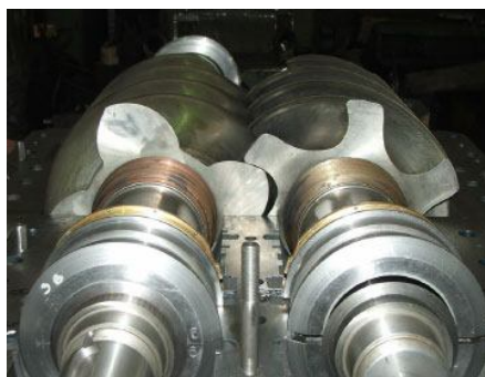
Рис. 2 Конструкция роторов ПВМ
