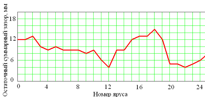
Рисунок 2 – Остаточный суммарный кинематический зазор между башмаками и проводниками
