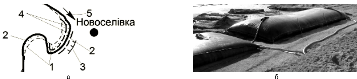
Рисунок 1. Схема укрепления берегов р. Ингулец (а) с помощью геотекстильных контейнеров (б): 1 – места накопления техногенного аллювия; 2 – размыв берега; 3 – оползень; 4 – геотубы; 5 – направление течения р. Ингулец.
