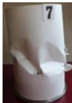
Рисунок 2 – Характерні картини пошкодження бокової поверхні попередньо стиснутих поздовжньою силою (меншою, ніж критична) оболонок, уражених уламковими фрагментами
