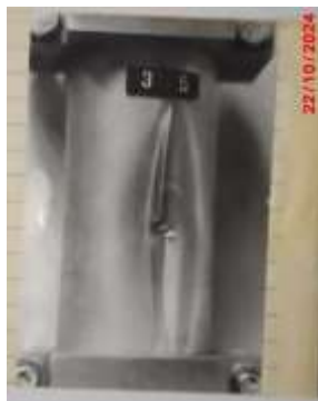
Рисунок 1 – Пошкодження бокової поверхні попередньо розтягнутої оболонки після удару жорстким циліндричним тілом з плоским торцем і малою швидкістю (зліва) та конусною передньою частиною (зправа) і високою швидкістю
