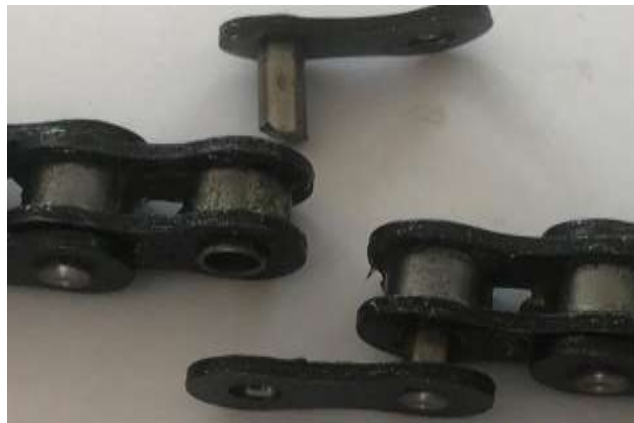
Рисунок 1. – Загальний вигляд фрагментів ланцюга після випробування його на розрив.
