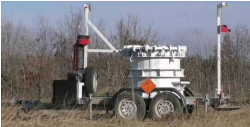
Рисунок 2 – Пересувний вибухозахисний контейнер.
