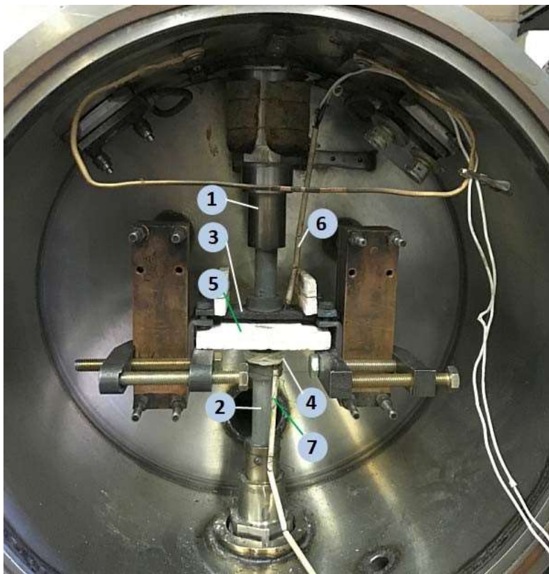
Рисунок 1 –Термокамера з елементами нагрівання та навантаження матеріалу:
