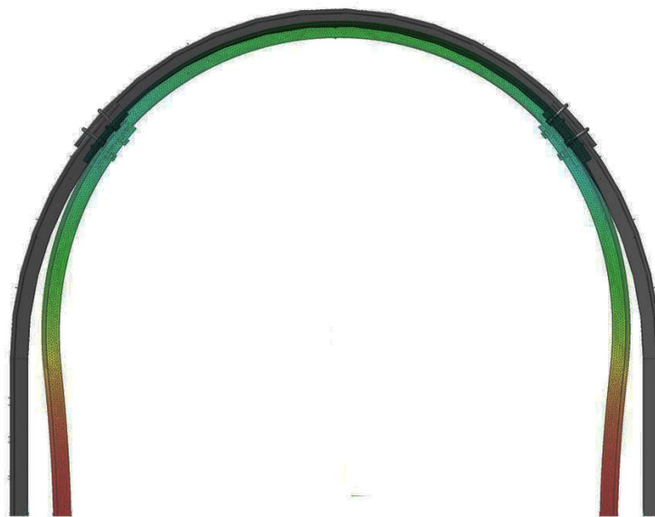
Рис. 3 Сравнение ненагруженной крепи относительно крепи под нагрузкой
