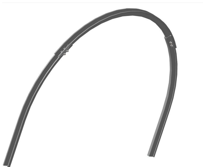
Рис. 1 Трехмерная модель металлической арочной крепи АП 27
