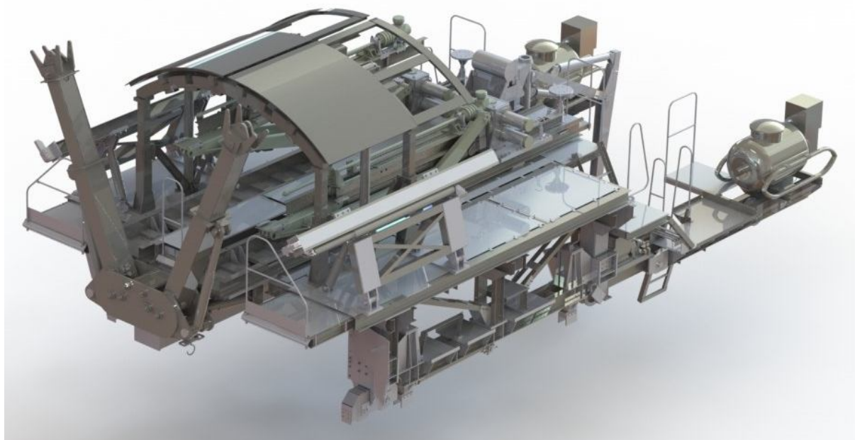
Рис. 1 Концептуальная компьютерная модель укладчика УТ-13
