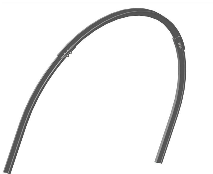
Рис. 1 Трехмерная модель металлической арочной крепи АП 27
