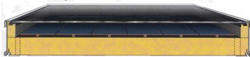
Рисунок. 1 Типичная конструкция плоского солнечного коллектора
