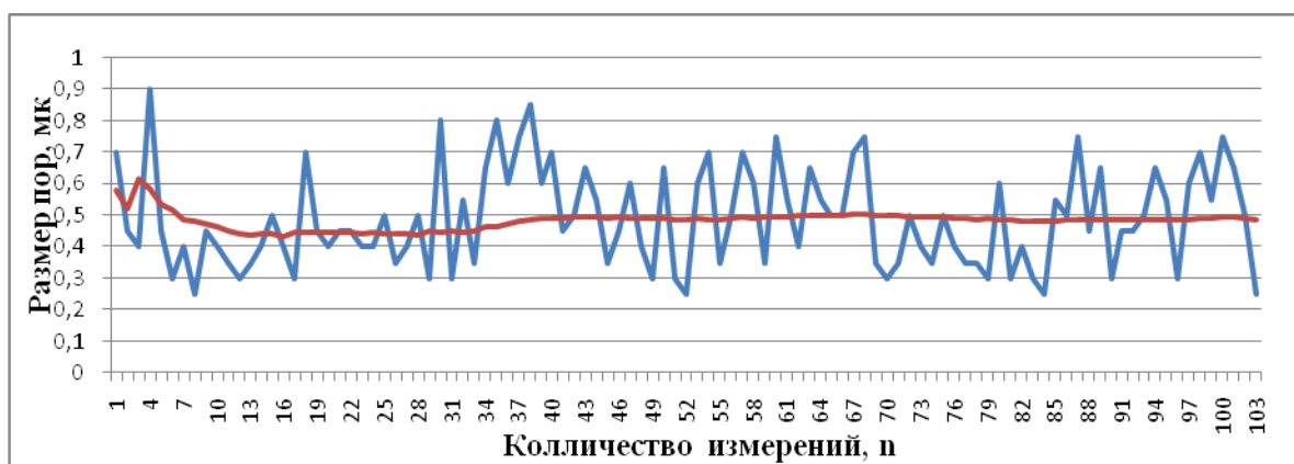
Рис. 3 - Изменение накопленного среднего числа пор в зависимости от подсчитанного общего числа пор для угля
