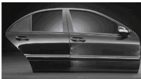
Рисунок 3 – Прозрачное нанопокpытие (слева) в сравнении с традиционной окpаской (справа) после 5 лет испытаний
